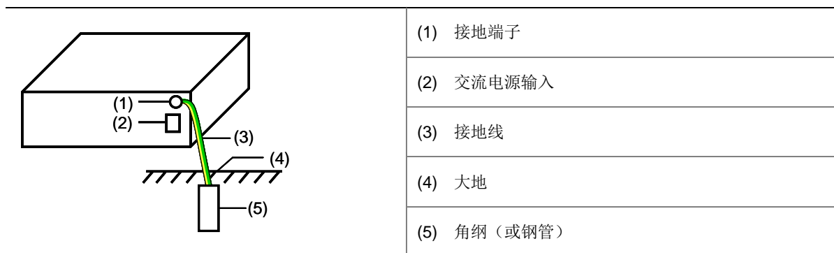
图2-14 接地安装示意图（埋设接地体）
